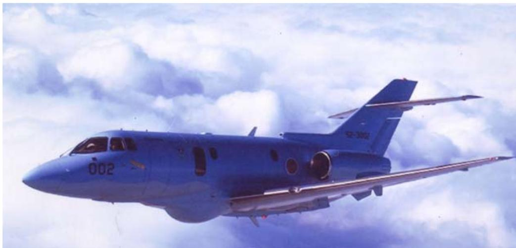
U-125Aは、救難捜索機MU-2の後継機と位置づけられています。MU-2に比べ、性能、能力ともに一段と向上しました。捜索レーダー、赤外線暗視装置の装備による捜索能力の向上、さらに援助物資投下機構を装備したことによって、遭難者に対する延命も含めた援助能力が向上したことが特徴です。近年は、作戦機の行動範囲が広がっており、それに対応した救難能力の強化を図ることができます。初号機は平成7年、航空自衛隊に納入されました。
