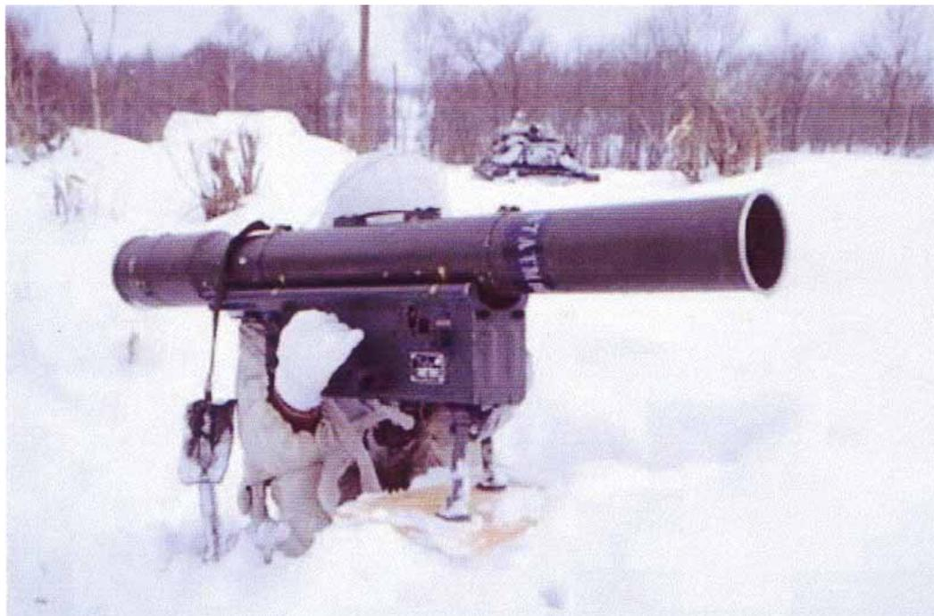
普通科部隊等に配備する中距離用の対戦車ミサイルで、通称「中 MAT」。79 式対舟艇対戦車誘導弾に次ぐもので、64 式 MAT の後継。最大の特色は、国産初のレーザ誘導方式になったこと。小型軽量化により人員携行や肩撃ちが可能で、照射と射撃の位置が自由に離せる特徴がある。
