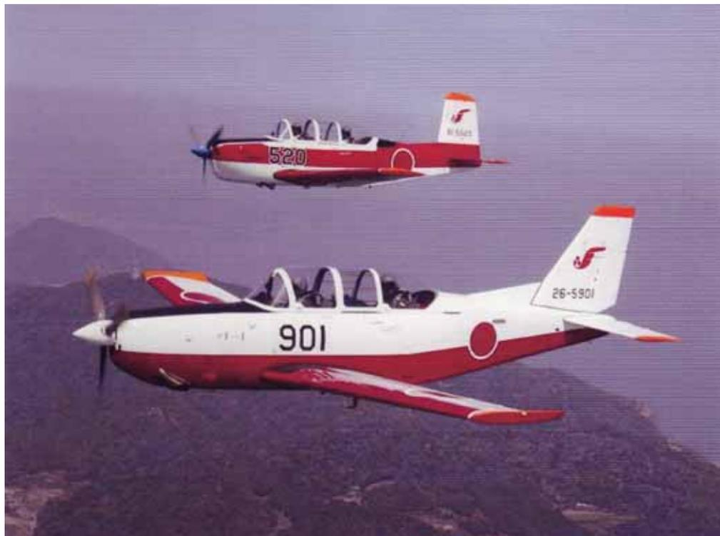
T - 7 初等練習機は、T - 3 の後継機として 12 年度に機種選定された。本機の特徴としては、ターボプロップ・エンジン搭載による性能向上と騒音低減が図られていること、及び冷房装置搭載とコックピットの操縦性居住性の向上が図られている。
